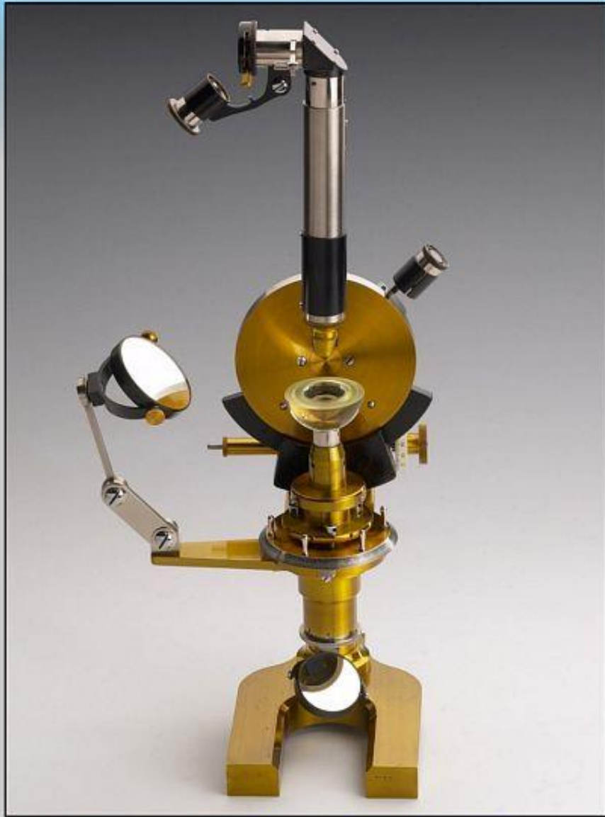
„Neues Krystallrefraktometer für den mineralogischen Gebrauch“, Fuess, ca. 1905
