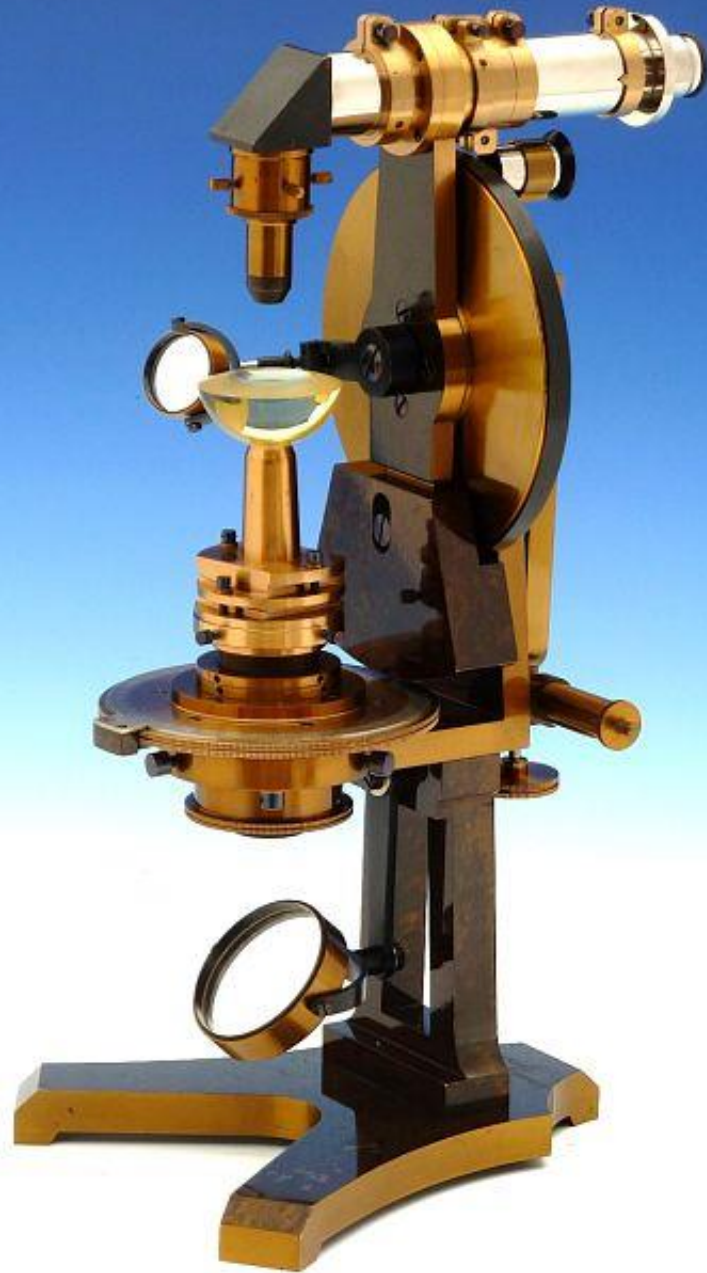
Abbe Refraktometer für den mineralogischen Gebrauch. Société Gènevoise pour la construction des instruments de physique, ca. 1905
