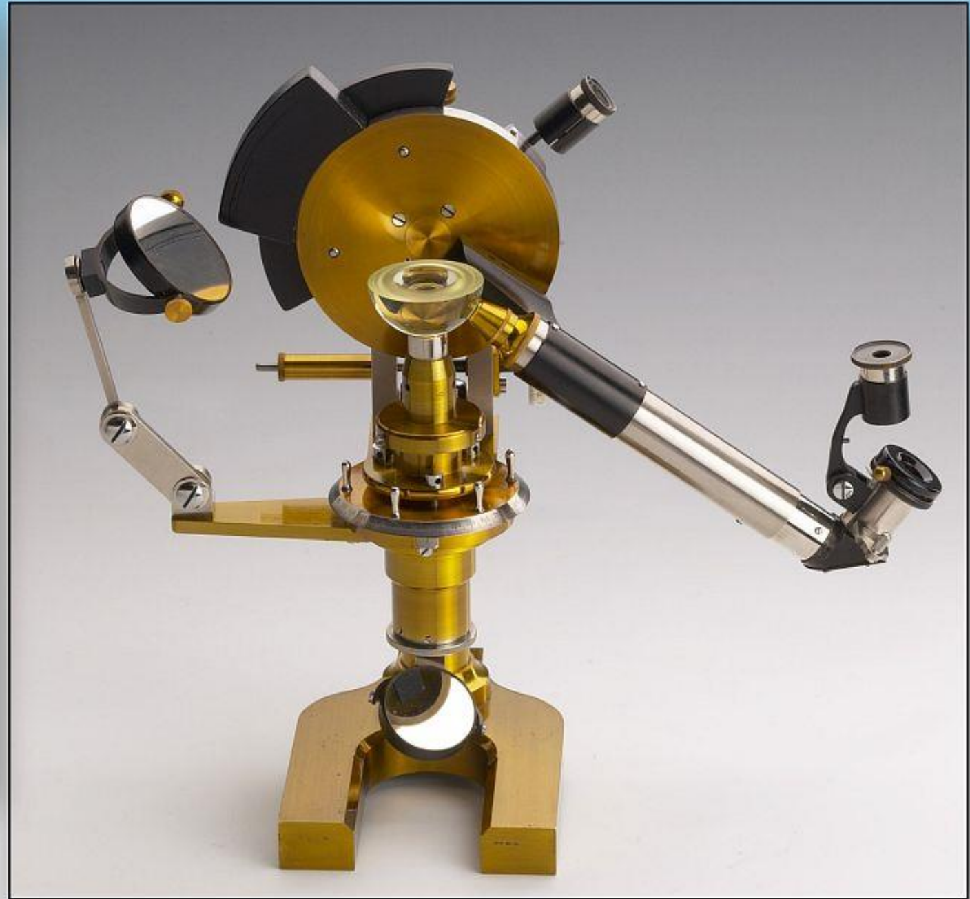
„Neues Krystallrefraktometer für den mineralogischen Gebrauch“, Fuess, ca. 1905
