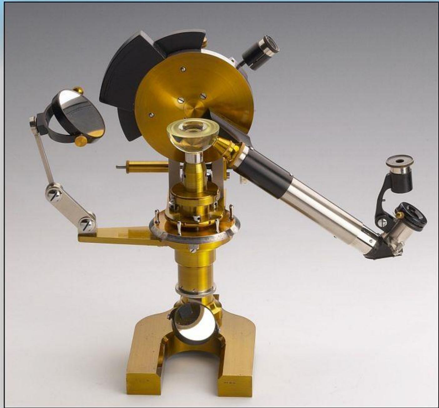
„Neues Krystallrefraktometer für den mineralogischen Gebrauch“, Fuess, ca. 1905
