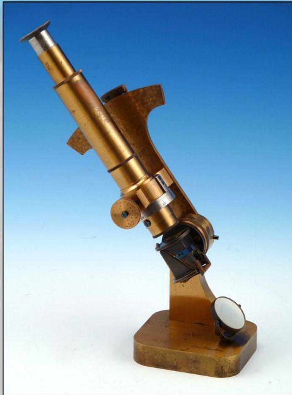
Abbe Refraktometer Zeiss Jena, ca. 1893, Seriennummer 86
